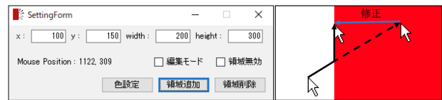
図3. (左) 試作システムの設定ウィンドウ. (右) カーソル進入不可領域での、カーソル座標の修正方法.
