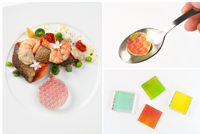
図 1 二次元可食レンチキュラレンズとその料理例。提案システムによって、ユーザは任意のレンズ仕様や形状をデザインできる。
