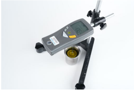
図 4: リオン粘度計 VT-06 ビスコテスタ (高粘度用) を用いた粘度の測定風景
