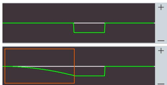
図 25 イーズイン処理を追加した刺激波形の例
